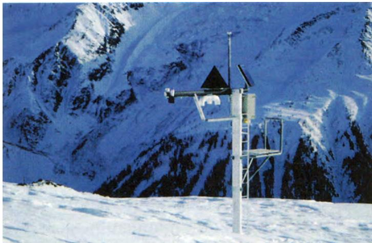
**Figure 7.2** Station automatique « niv ose ». La hauteur de neige, la temp erature et la vitesse du vent sont mesur ees toutes les heures et sont transmises via satellite.
