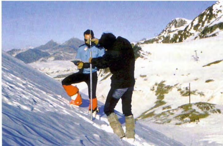
**Figure 7.1** Le sondage par battage, compl et e par le profil stratigraphique, permet de rep erer les zones de faible r esistance dans le manteau neigeux.
