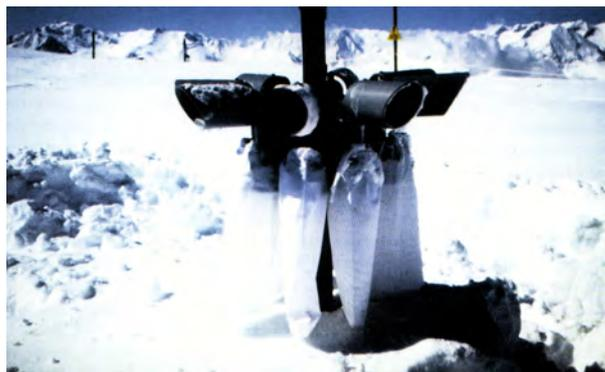
**Figure 7.7** Le driftom etre, appareil renseignant sur le transport de neige par le vent (direction et intensit e). Ce mat eriel a  et e mis au point en soufflerie puis test e en situation r eelle. Il fournit une donn ee hautement pr edictive des avalanches dues au transport  olien.
